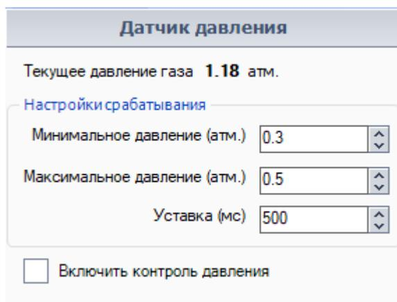
Рисунок 251 – Датчик давления
