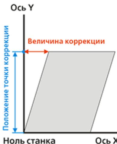
Рисунок 79 – Коррекция перекоса балки
