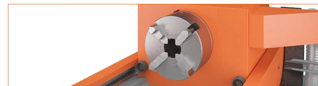
Автоматический захват для прямоугольной и круглой трубы
