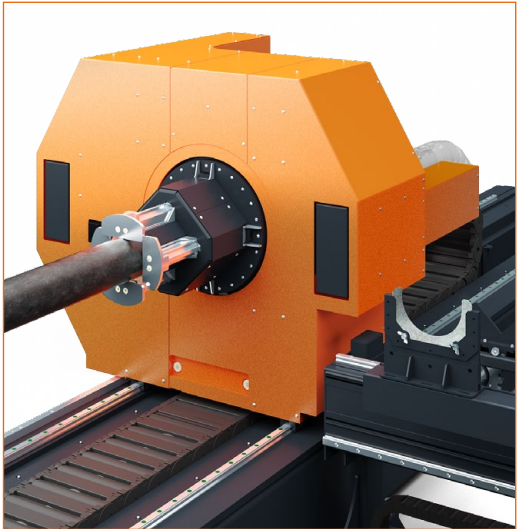
Автоматический захват для прямоугольной и круглой трубы
